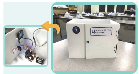
서울대 AIED-Con AI융합교육 경진대회 2021 출품작: 센서와 마이크로비트를 활용한 얼굴인식 사물함 만들기 (중학교 기술가정 수업 활동)
